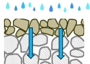
※SPアスコンは雨水を透水させ、転圧によって締まり、水がある場面での補修効果が飛躍的に向上しました！！
